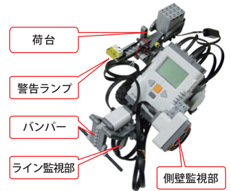
搬送ロボット
